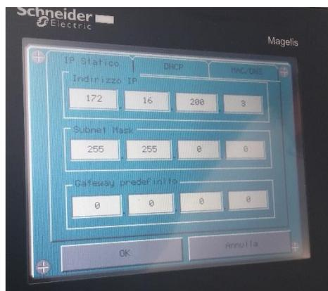
Figura 2 Configurazione di rete tramite touch panel
