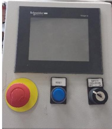
*Figura 10 Fungo di emergenza per l'interruzione del lavoro*
